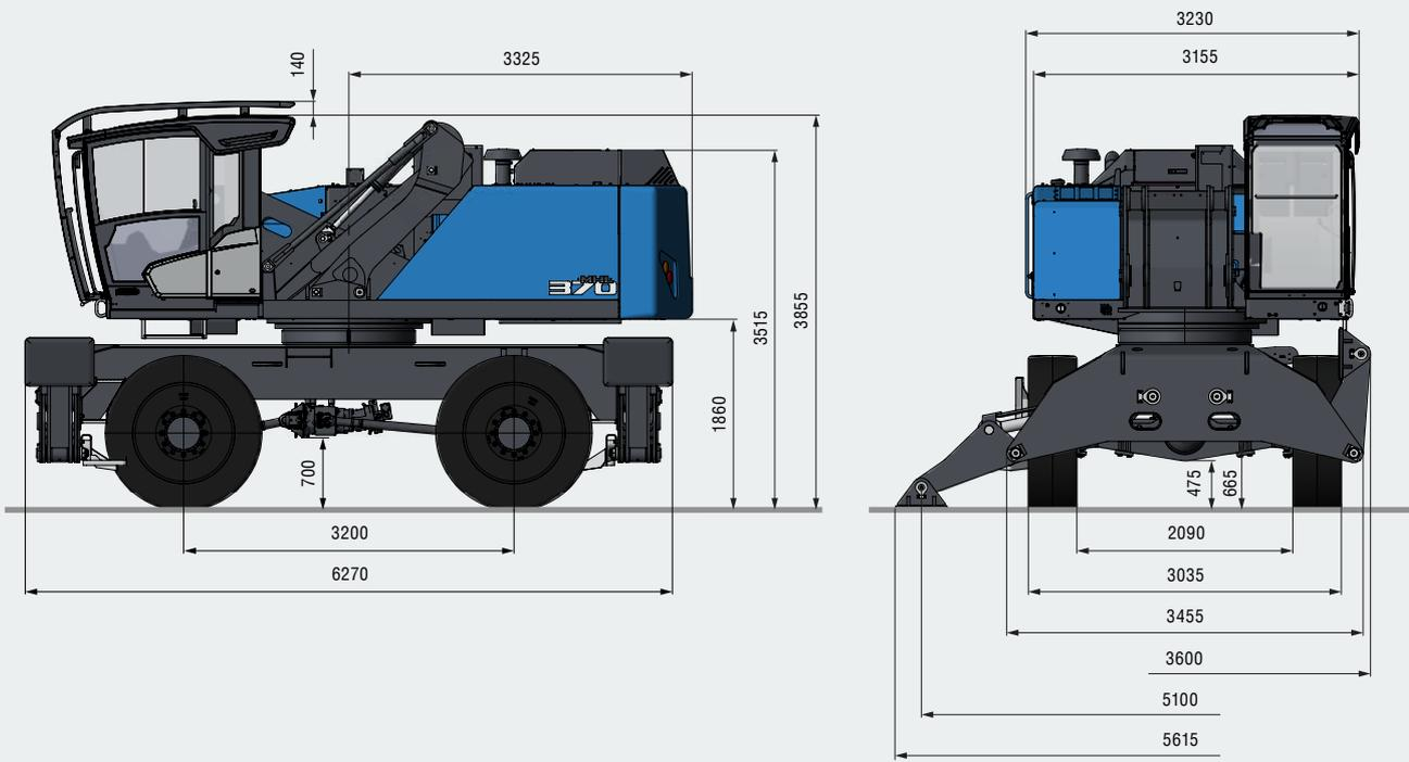
With vertically and horizontally adjustable cabin | Mit hoch- und vorfahrbarer Kabine | Avec cabine à élévation et à avancement
