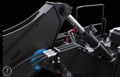
Cojinete del cilindro de la pluma de fundición reforzado
