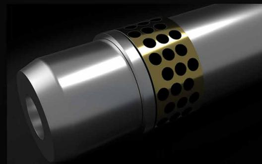
Los casquillos utilizados en los puntos de conexión pluma-balancín y pluma-chasis, llevan incrustado en la estructura interna partículas de bronce-grafito y permiten ampliar los plazos de lubricación y minimizan el desgaste de los bulones gracias al grafito, un material con una capacidad de absorción y retención de la grasa muy alta.
